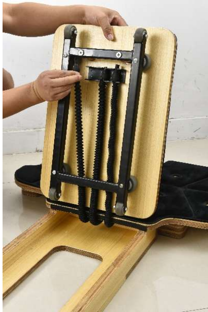
Nr. 3: Reformer-Basis -Widerstandsbänder unter der Platte befestigen ( ACHTUNG: Bänder MÜSSEN unter der Metallstange geführt werden)
